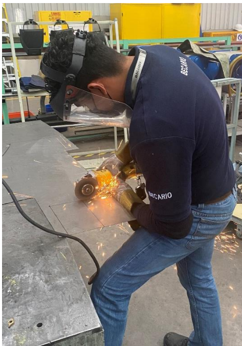
Ilustración 23. Trabajo de corte de piezas para estación de trabajo
