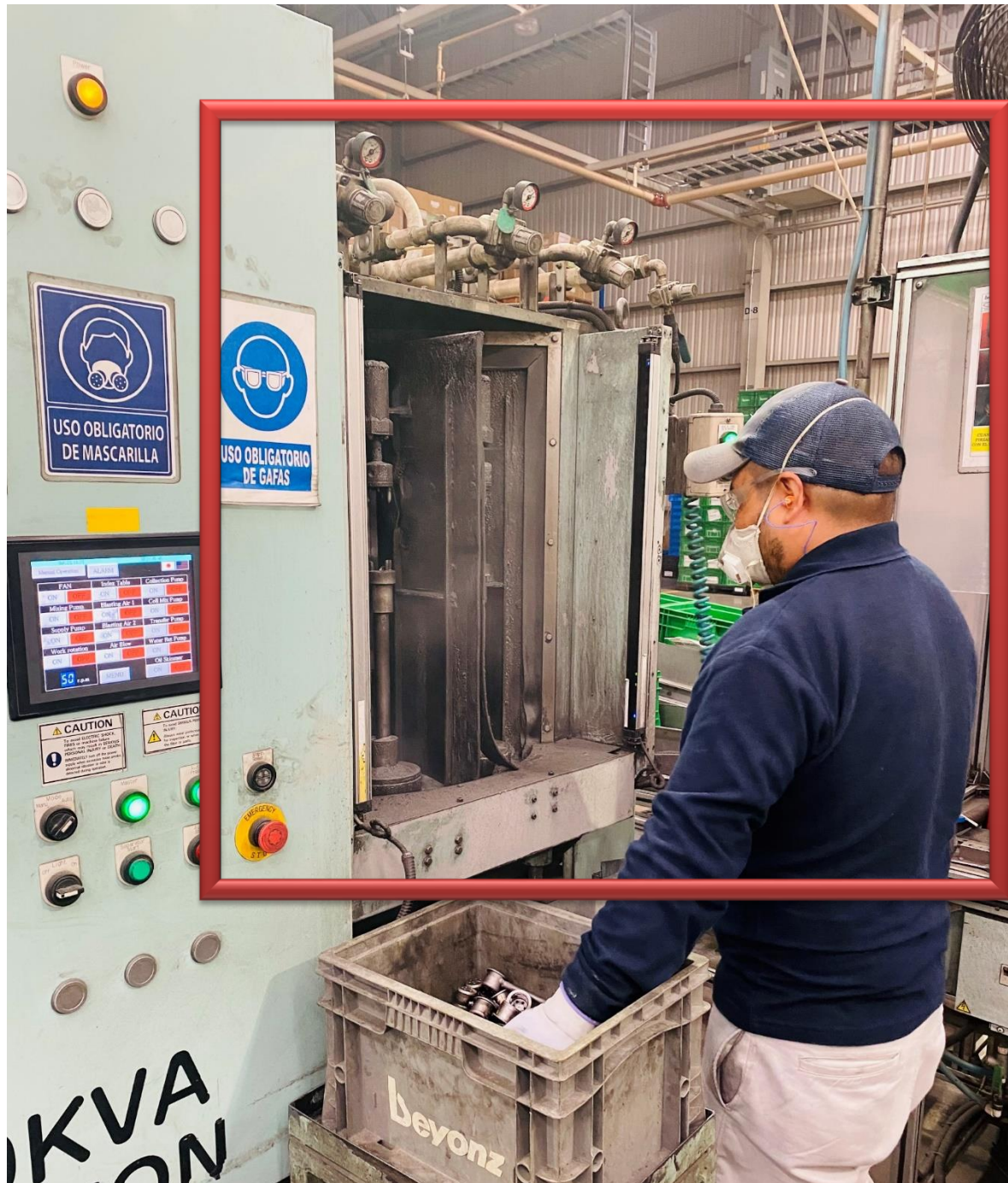
Ilustración 30. Vista frontal de la máquina, parte por donde sale la presión de las partículas.
