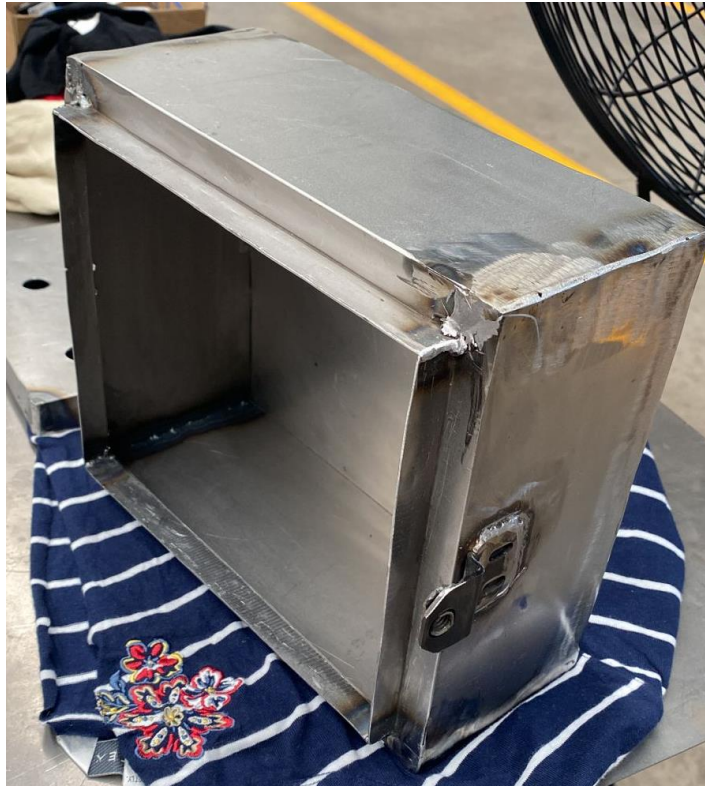
Ilustración 44. Caja para la botonera
